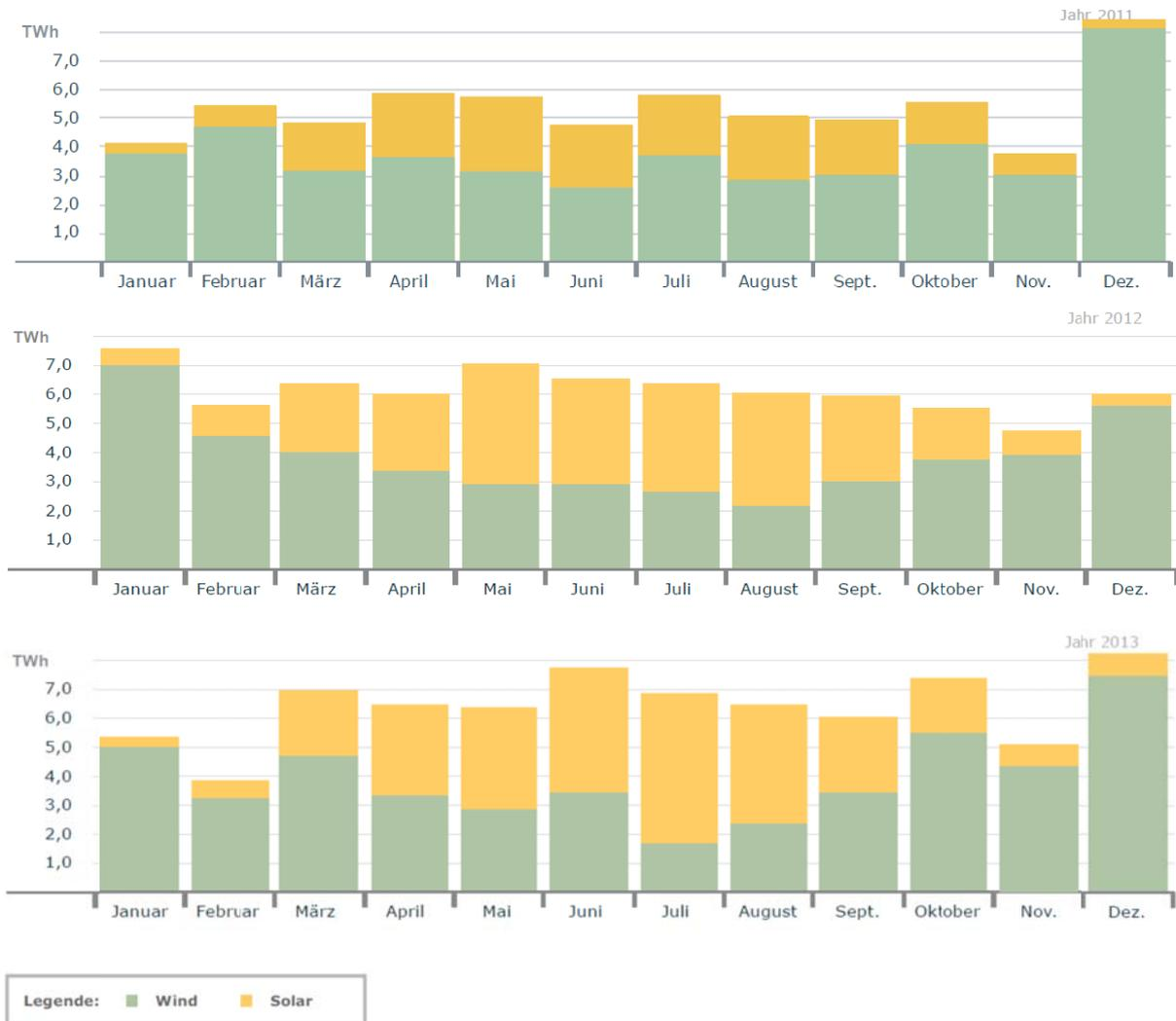
**Abbildung 33: Monatliche PV- und Windstromproduktion der Jahre 2011-2013 [ISE4]**
