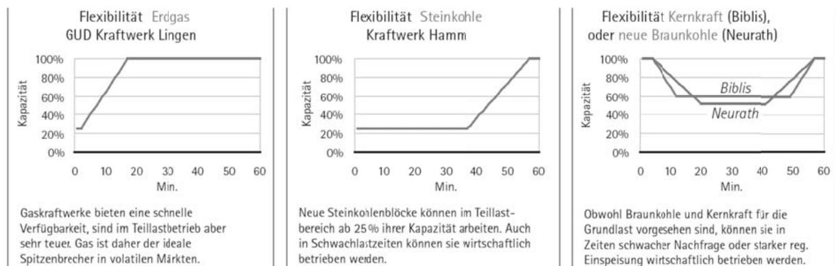
**Abbildung 58: Verfügbarkeit von Kraftwerken [VGB]**
