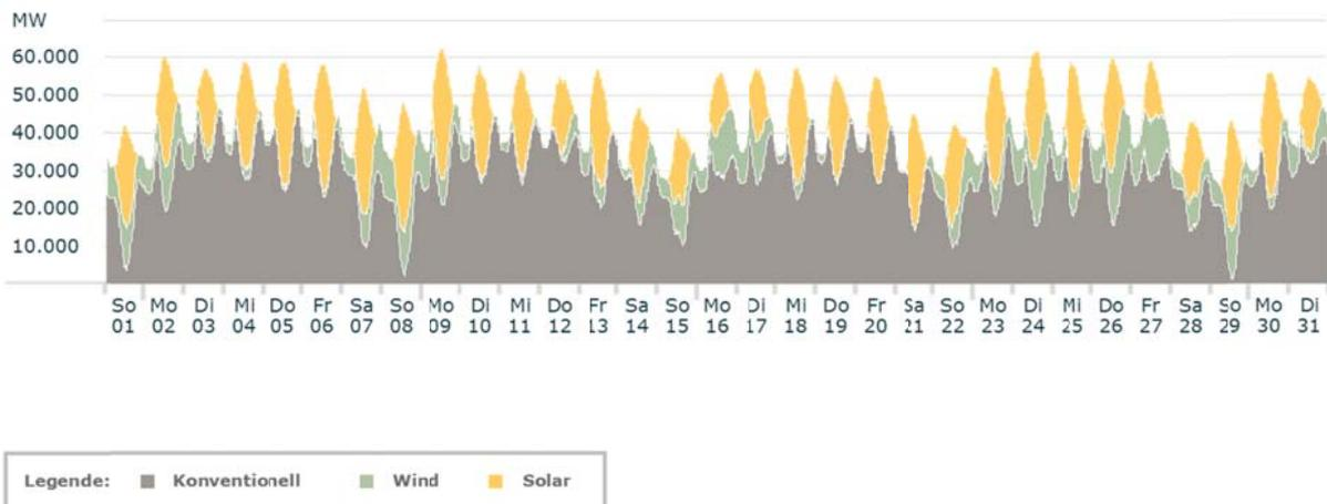
**Abbildung 56: Simuliertes Last- und Stromerzeugungsprofil auf Basis beispielhafter Wetterdaten für eine sonnige Maiwoche bei installierten Leistungen von 50 GW PV und 40 GW Wind, die Spitzenleistungen von 35 GW PV und 21 GW Wind liefern (B. Burger, Fraunhofer ISE)**
