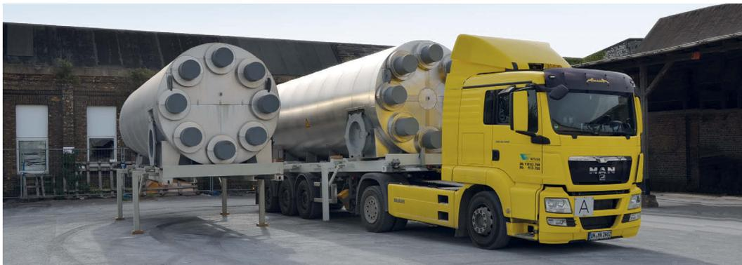
**Mobile Sorptionsspeicher** können Wärme speichern und transportieren, sodass Bereitstellung und Nutzung örtlich entkoppelt sind. Das Bild zeigt den Wechsel der Speicher-Container beim Wärmeabnehmer.
